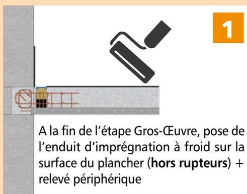
A la fin de l'étape Gros-Cœuvre, pose de l'enduit d'imprégnation à froid sur la surface du plancher (hors rupteurs) + relevé périphérique
