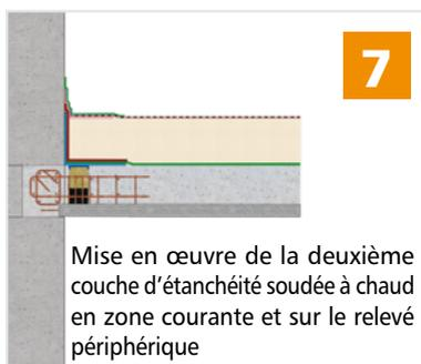
Mise en œuvre de la deuxième couche d'étanchéité soudée à chaud en zone courante et sur le relevé périphérique
