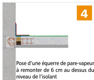
Pose d'une équerre de pare-vapeur à remonter de 6 cm au dessus du niveau de l'isolant
