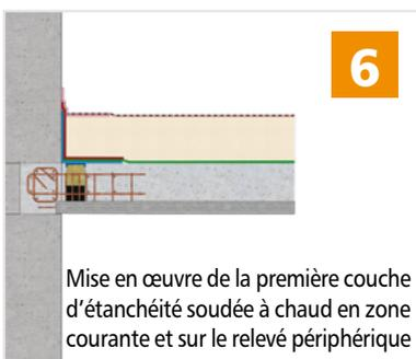
Mise en œuvre de la première couche d'étanchéité soudée à chaud en zone courante et sur le relevé périphérique
